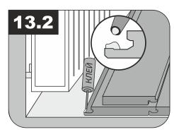
Сдвиньте плашки кварцевого ламината под выступающую помеху и, плотно прижав, соедините с плашками предыдущего ряда.
