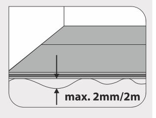
4.7 При проверке выравнивающего слоя контрольным 2-метровым правилом, передвигаемым во всех направлениях, необходимо проводить не менее девяти измерений на каждые 50 – 70 м². Отклонение поверхности выравнивающего слоя от плоскости не должны превышать 2 мм.
