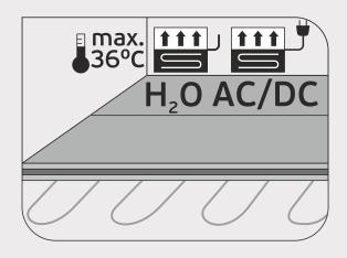
При укладке SPC-покрытия высокой плотности (кварцевого ламината FARGO) на подогреваемые полы систему нужно отключить за 3-4 суток до начала укладки и включить после завершения всех работ по монтажу напольного покрытия.
