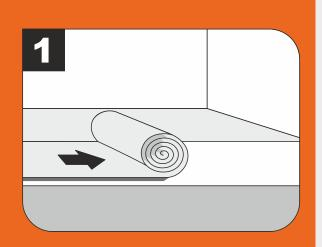
7.1 Для обеспечения комфорта при эксплуатации расстилается плотная подложка толщиной 1,5 мм. Подложка укладывается встык и закрепляется при помощи клейкой ленты по всей длине стыка.
